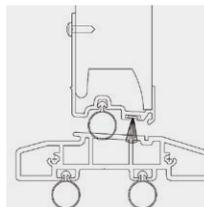
Un double joint tubulaire en silicone assure une étanchéité optimale.
